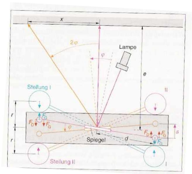
Abb. 5: die Kräfte im Inneren der Gravitationsdrehwaage
