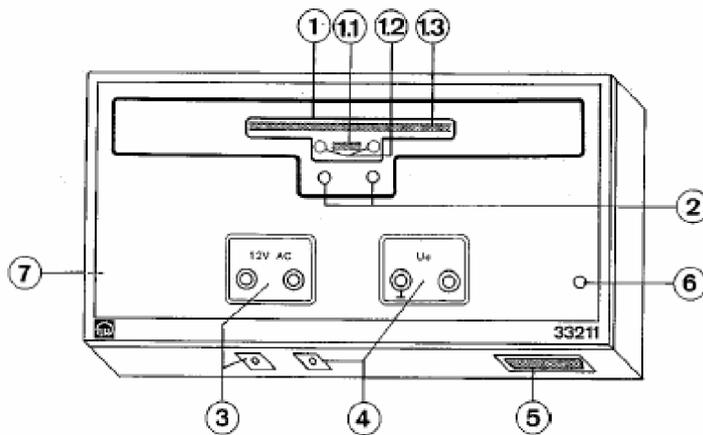
Abb. 3: der Aufbau des InfraRot Positions-Detektors.
