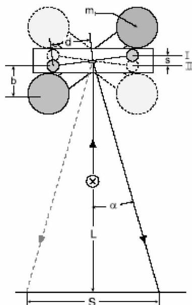
Abb. 2: die Stellung der großen Kugeln hat Einfluss auf die beiden kleinen Massen. Es kommt zu Schwingungen.
